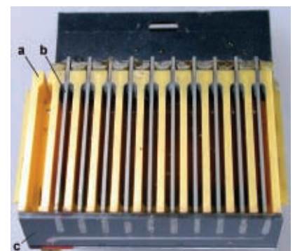
Abb. 7: Keramischer Trätkörper (a) mit eingeklebten piezoelektrischen Aktoren (b) und Mikrosystem (c) (Ansicht von unten)
