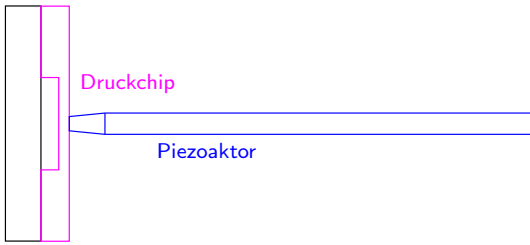
Bild 7: Antriebssystem mit in Membranauslenkungsrichtung frei schwingendem Aktor (Prinzipische Skizze; vergleiche Bild 6)
